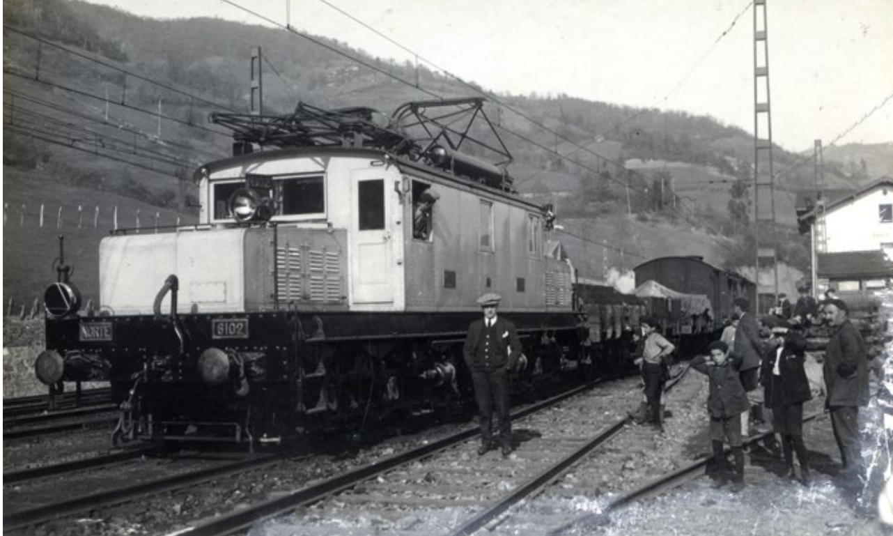
Figura 16. Locomotora eléctrica 6102 en Pola de Lena en cabeza de un tren de mercancías. La electrificación del tramo entre Ujo y Busdongo, puesta en servicio oficial el 1 de enero de 1925, puso fin a la época del vapor en el puerto. En pocos lugares estaba más indicada la electrificación de la tracción que en Pajares, y aunque las máquinas eléctricas permitieron evitar la enorme penosidad del trabajo en las locomotoras de vapor en la línea, en realidad su implantación se debió sobre todo a razones económicas: el vapor simplemente no podía hacer frente a los crecientes tráficos. (Original de la colección del Museo del Ferrocarril de Asturias, reg. P.85.9312)
