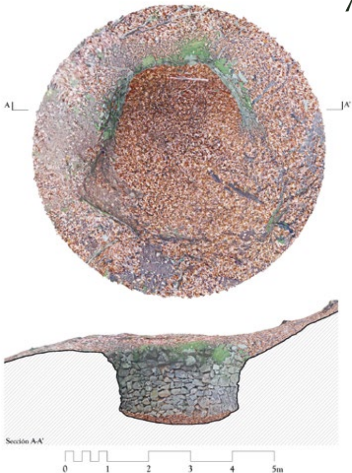
Figura 17. Planta y sección del Pozo Bormayur, obtenido mediante fotogrametría. (Figura del autor)
